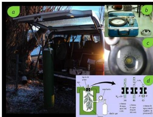
Figura 4.a) y b) cámara de presión Scholander utilizada para medir potencial hídrico c) detalle de observación de la columna de agua de la sección de tallo. d) grafica ilustrativa de medición del potencial hídrico
